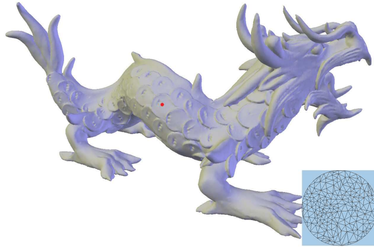
Figura 1.5: Exemplo de uma técnica de processamento de malhas mostrada no Asian Dragon da XYZ RGB Inc. A superfície ao redor do vértice selecionado (em vermelho) é parametrizada em duas dimensões e mostrada no canto inferior direito.
